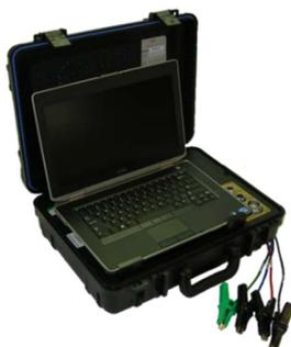
ポータブルで包括型なMCE®は、市場で最も包括的な静的モーターテストツールです。一連の強力な非破壊テストを通じて、MCEは、モータおよびそれらに関連する回路を徹底的に分析し、高抵抗接続、絶縁劣化、ステータ故障、ロータ欠陥、およびエアギャップ偏心を早期に検出します。ユニットの静的な性質により、MCEはプラント停止中の状態監視と品質保証アプリケーションの両方に最適です。
