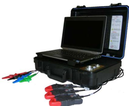
動的テストとして、EMAXは、モータが動作している間にデータを収集することによって、モータおよびそれらに関連する回路を正確に評価します。従って、電力を遮断したり、生産を中断する必要がなくなります。EMAXは、電流および電圧の3つの相を同時に評価し、ロータ、ステータ、エアギャップ、電力回路、および電力品質故障の早期表示に加え、電力品質および効率データを提供します。突入電流・起動電流を検出し、プロセス分析を行えるEMAXは、そのクラスにおいて最も完全に正確な動的テストです。
