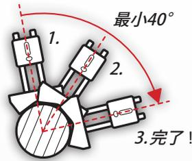
EasyTurn™ 機能により、ターンのどこからでも測定プロセスを始められます。わずか20°の間隔をあけた3か所にシャフトを回転させ、測定値を登録すると、測定完了です。
